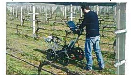
Determinação do teor de humidade do solo recorrendo ao georadar
